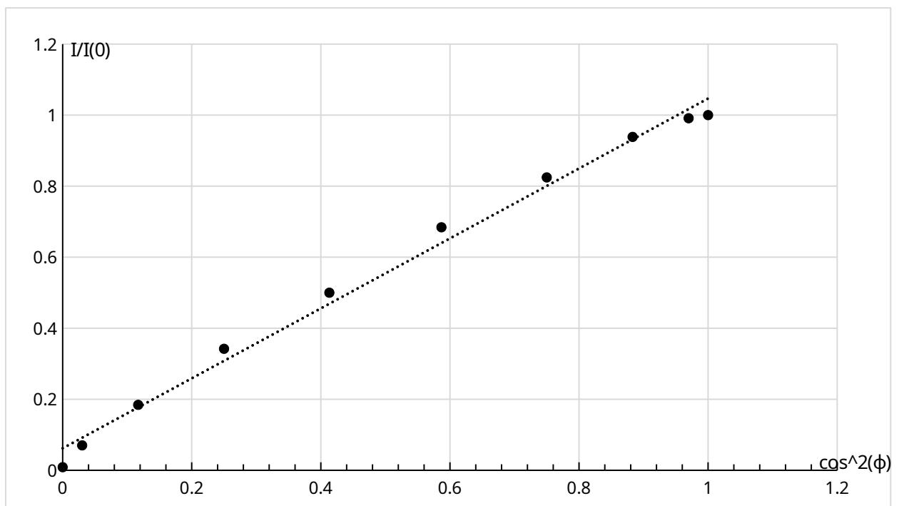
Рисунок №1 – Проверка закона Малюса.
