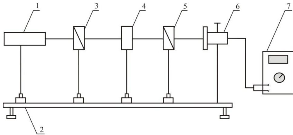
1 – газовый лазер; 2 – оптическая скамья; 3 – поляризатор; 4 – четвертьволновая пластина; 5 – анализатор; 6 – фотодетектор; 7 – цифровой мультиметр.
